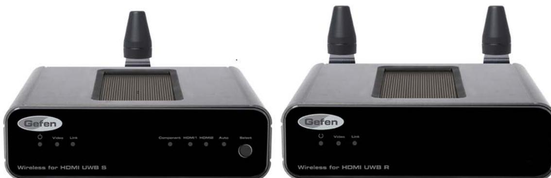
**Figura 19 - Transmissor e receptor UWB para multimídia de alta definição da Gefen. Usa o grupo 1 do espectro para transmitir vídeo de alta resolução (1080p) e som de 6 canais, comprimidos. (Gefen)**
