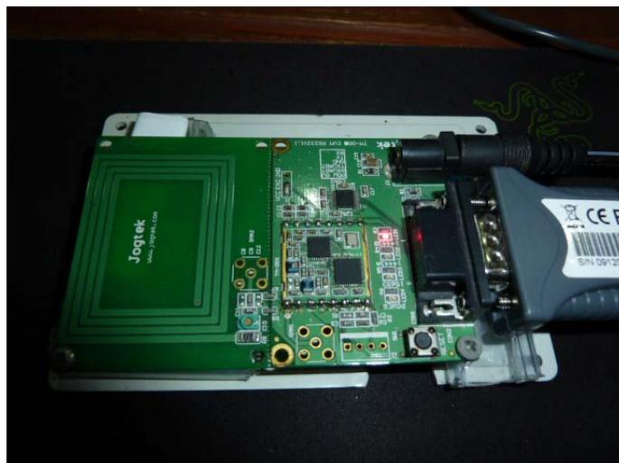
Figura 28 - Módulo *RFID* Jogtek *TM-001*
