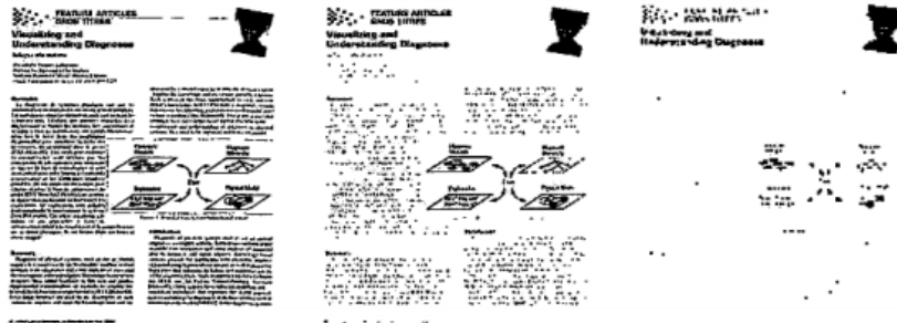
Figura 8. Exemplo de várias resoluções de uma mesma imagem. As duas imagens da esquerda apresentam maior resolução e formam as camadas diferenciais do JBIG. A imagem da direita apresenta menor resolução e forma a camada base do JBIG.
