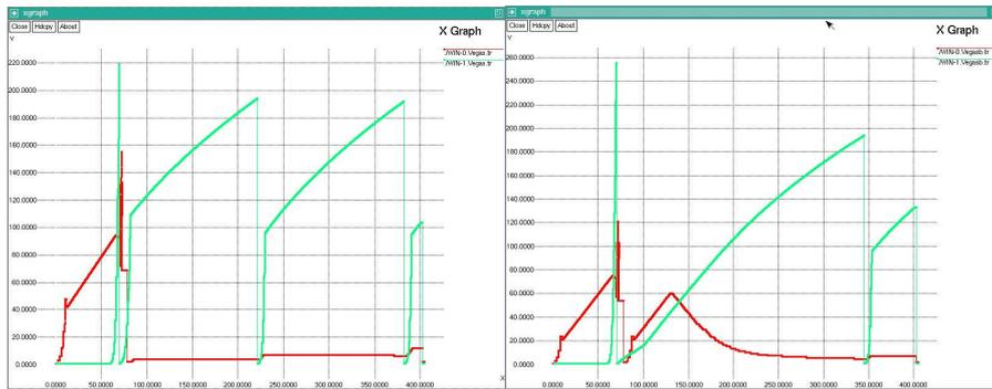
**Figura 3 – Simulação ns-2 - Dinâmica de Janela de congestionamento VegasXTahoe (Esq.); VegasBXTahoe (Dir.).**
