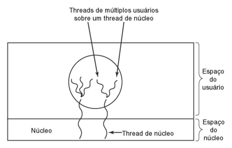
Multiplexação de threads de usuário sobre threads de núcleo
