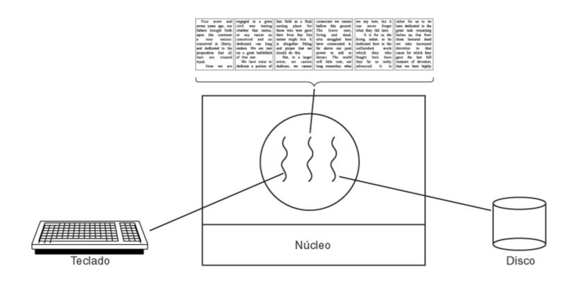
Um processador de texto com três threads
