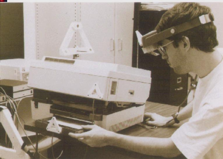
Durante a manutenção duma impressora Laser o utilizador vê como remover a gaveta de papel através da imagem *wireframe* computadorizada.
