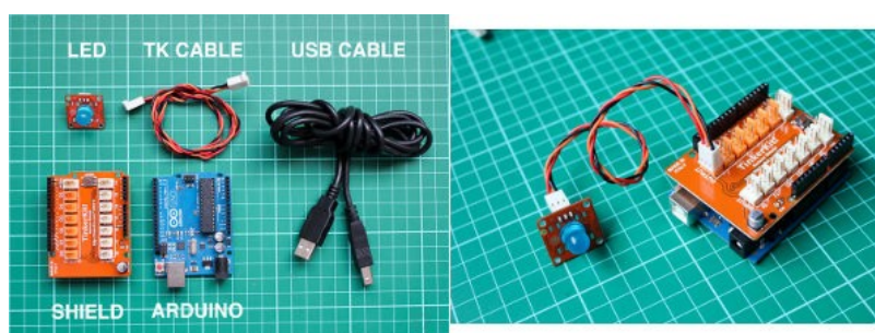
Figura 20: Principais componentes do Tinkerkit um exemplo de conexão de um led.
