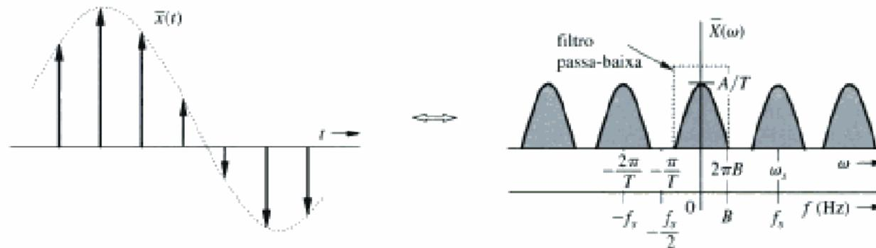
Como o trem de impulsos é um sinal periódico, pode ser substituído pela série trigonométrica de Fourier:
