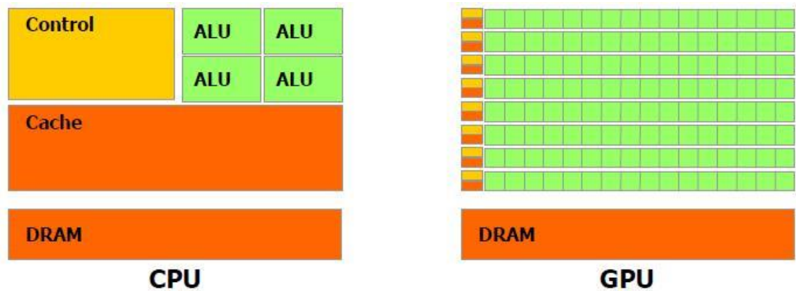
Figura 3-3: Arquitetura de uma CPU vs. de uma GPU
