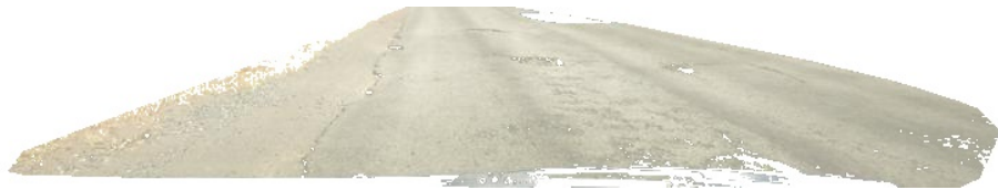
Figura 14 - Imagem com sucesso após a seleção da cor predominante e do algoritmo convex hull
