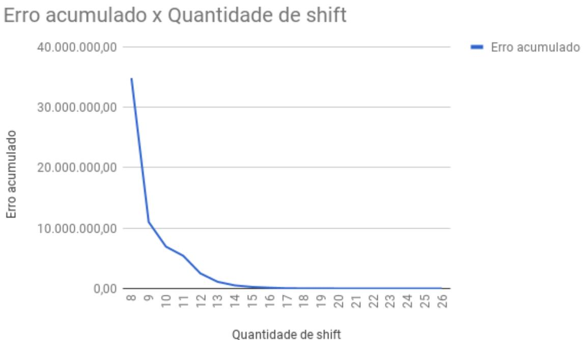
**Figura 4.12** Gráfico que mostra o erro acumulado para diferentes *shift* no cálculo da variável *weightedSum* do *histogramGrayScale*.
