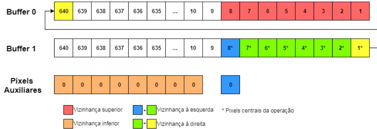
**Figura 4.26** Representação de como os pixels são lidos dos buffers no sétimo estado do módulo de dilatação.
