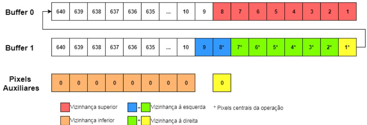
**Figura 4.22** Representação de como os pixels são lidos dos buffers no quinto estado do módulo de dilatação.
