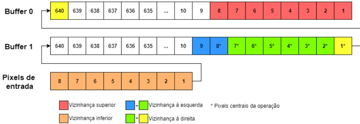
**Figura 4.18** Representação de como os pixels são lidos dos buffers no terceiro estado do módulo de dilatação.
