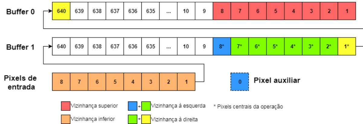
**Figura 4.20** Representação de como os pixels são lidos dos buffers no quarto estado do módulo de dilatação.
