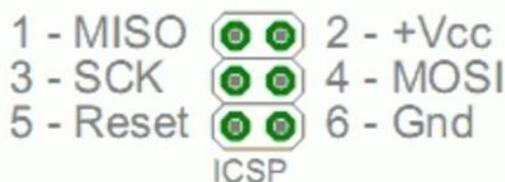
Figura 14 - Conexões SPI na placa do arduino
