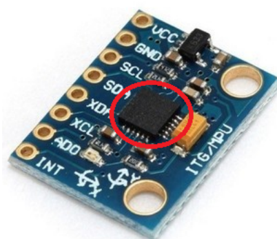
Figura 2.6 MPU6050 (circulado em vermelho), circuito integrado que possui giroscópio e acelerômetro fabricado com tecnologia MEMS.
