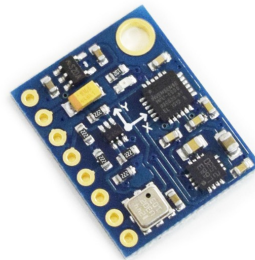
Figura 3.5 Placa GY-87 com CIs MPU6050 (giroscópio, acelerômetro) e HMC5883L (magnetômetro).
