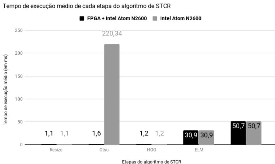
Figura 6.2: Duração média, em milissegundos, de cada etapa do algoritmo de STCR na arquitetura híbrida proposta em comparação com a abordagem apenas em software
