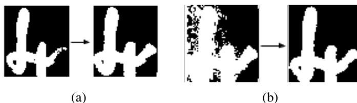
Figura 2.4: 2.4(a) ilustra a reconstrução de detalhes do caractere, através de uma operação de dilatação. 2.4(b) ilustra remoção de ruídos, através de uma operação de erosão.
