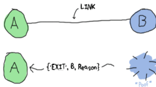
Figura 8: Fluxo de funcionamento de notificação usando Links
