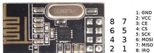
Figura 13 - Pinos do módulo nRF24L01+.
