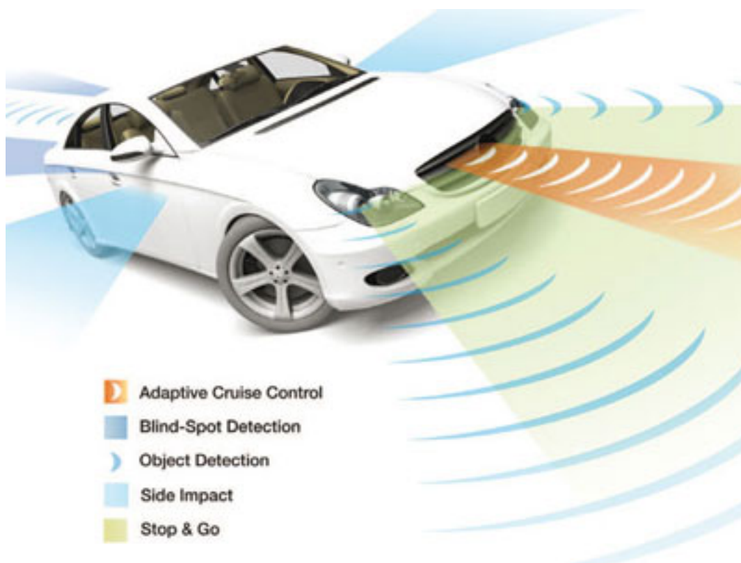
Figura 7 – Assistências quem um radar pode oferecer para um veículo
