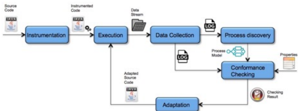
Figura 1- Esquema do sistema para fazer mineração de processos em middleware
