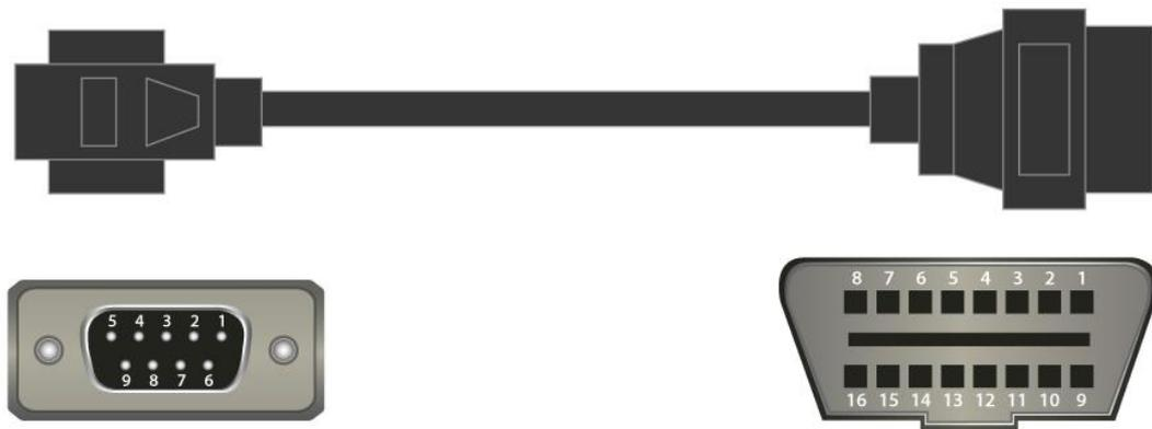
Figura 8. Configuração da pinagem do cabo OBD-II.
