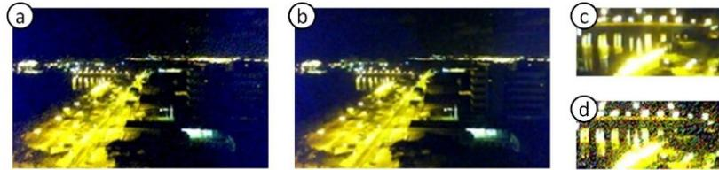
Figura 1: Em (a), imagem original não comprimida da cidade de Recife, com paleta de 24 bits (8 bits por canal RGB, aproximadamente 16 milhões de cores). Em (b), a mesma imagem após a aplicação do algoritmo, agora com paleta reduzida (1 bit por canal RGB, 8 cores). Em (c) e (d), ampliação das imagens
