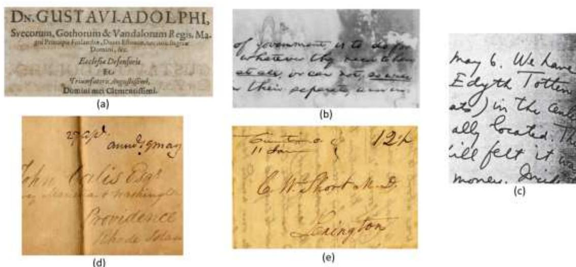
**Figura 2 - Artefatos comuns a documentos antigos: a) desgaste do papel; b) manchas; c) não-uniformidade de iluminação; d) marca de dobra; e) interferência frente-verso.**
