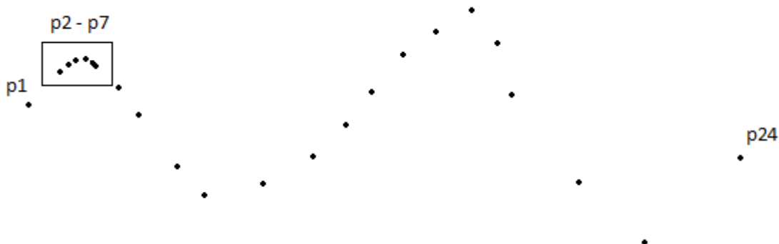
Figura 2.3 – Exemplo de candidato a stop encontrado através do método CB-SMoT.
