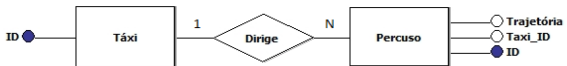
Figura 4.1 – Modelo Entidade-Relacionamento para a aplicação desenvolvida
