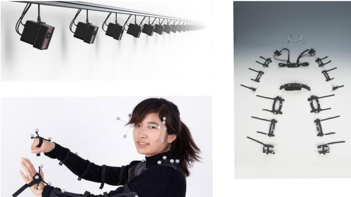
FIGURA 22 MARCADORES DO SISTEMA DE RASTREAMENTO INTEGRADO À CAVE.
