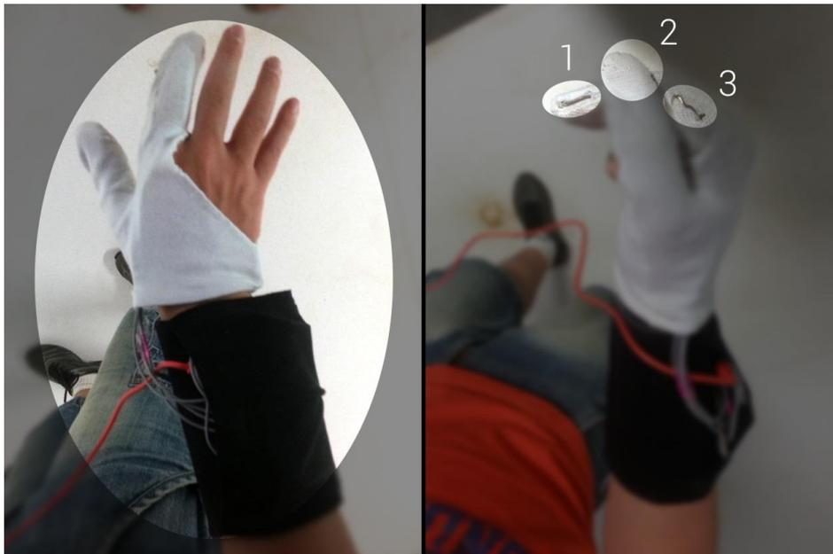
FIGURA 27 PROTÓTIPO NO BRAÇO DO USUÁRIO SENDO UTILIZADO. 1, 2 E 3 INDICAM AS LOCALIZAÇÕES DOS FIOS CONDUTORES.
