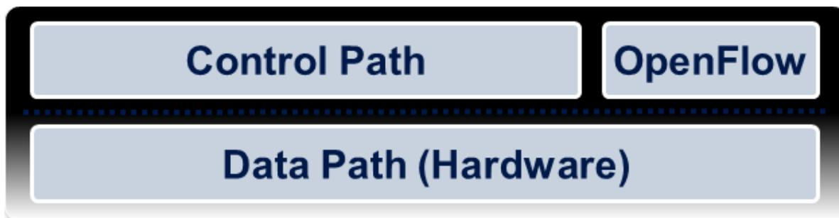
Figura 2. Arquitetura interna de um *switch* OpenFlow. Figura adaptada [13].
