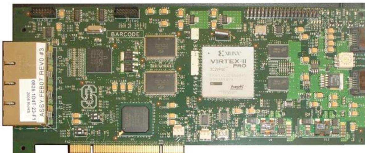
Figura 5. Fotografia de uma placa NetFPGA-1G [7].
