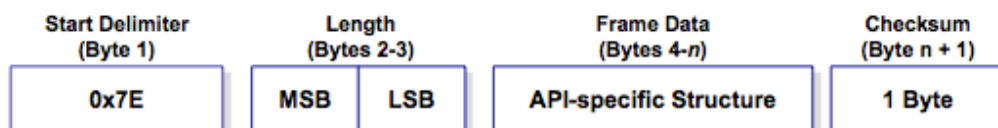
Figura 4-17. Estrutura do Pacote ZigBee no Modo API (Digi, 2010).
