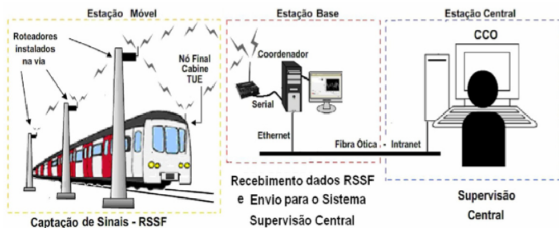
Figura 2-3. Visão Geral do Sistema RailBee (Araújo, 2009).
