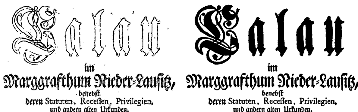
Figura 4.6: (esquerda) Imagem limiarizada resultante da aplicação do algoritmo e (direita) Ground Truth correspondente.
