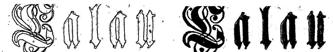
Figura 4.8: (esquerda) Resultado da limiarização comprometido pela má classificação dos pixels devido ao uso de uma janela de tamanho inadequado e (direita) limiarização da mesma imagem com tamanho de janela calculado manualmente.
