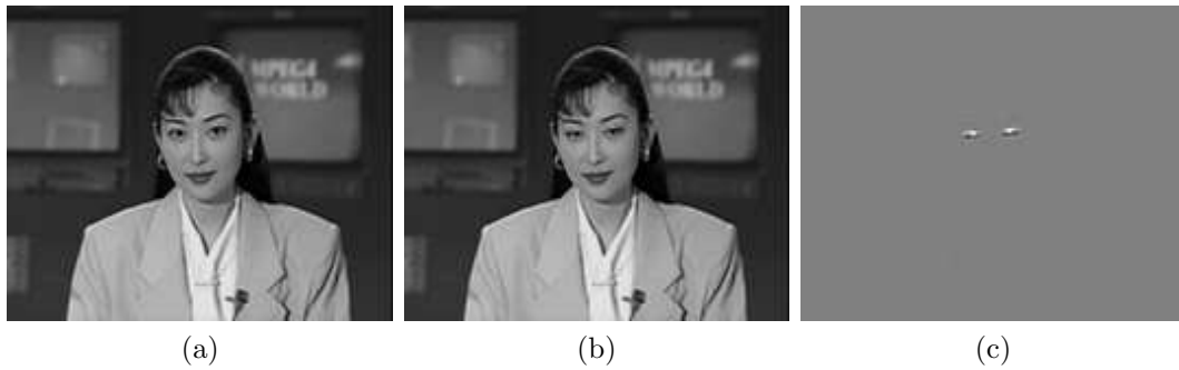
Figura 2.3: Correlação temporal: (a) quadro anterior, (b) quadro atual, (c) diferença residual entre quadros (a) e (b) (centralizado no tom cinza médio \frac{I_{max}}{2} )
