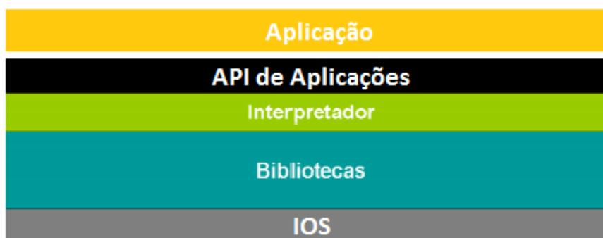
**Figura 4 - Visão Geral da Arquitetura do OpenTV**
