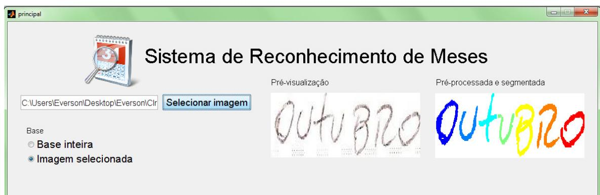
Figura 2 – Resultado de pré-processamento da imagem selecionada.
