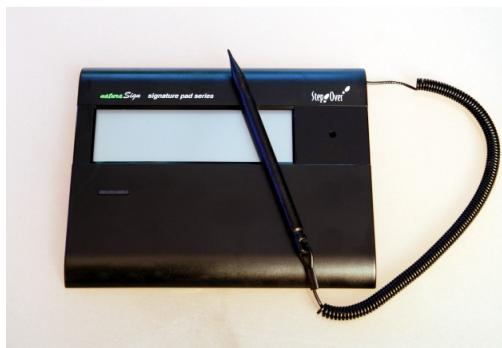
Figura 3.1 – Aparelho eletrônico de assinatura digital [19].
