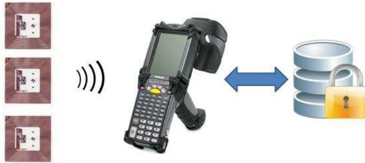
**Figura 2.1** Sistema RFID
