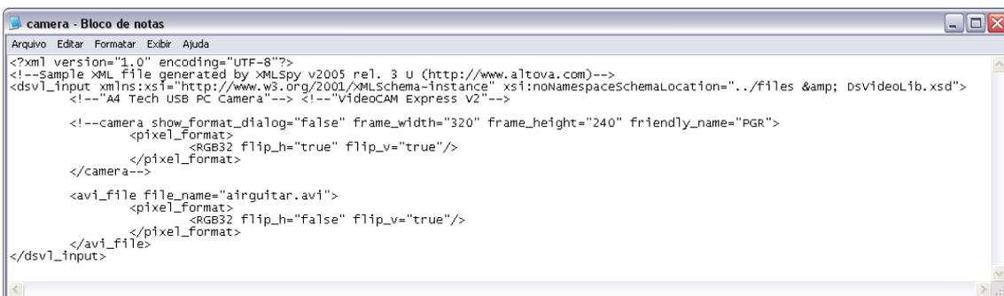
Figura 3. Arquivo “camera.xml”, contendo as configurações sobre a fonte de entrada para a aplicação exemplo.
