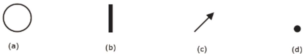
Figura 4.2 – Elementos gráficos de uma Petri Net (a) lugar, (b) transição, (c) arco, (d) token
