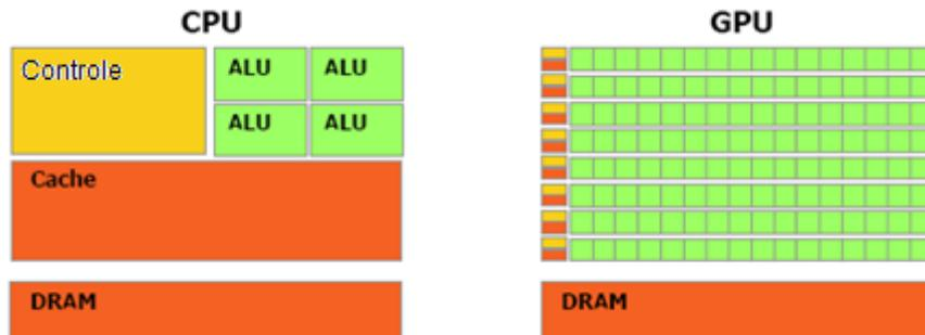
Figura 7. Arquitetura de uma CPU vs de uma GPU. Fonte: NVIDIA [5].
