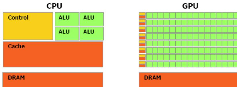
Figura 2.2 - Disposição dos Transistores na CPU e na GPU.
