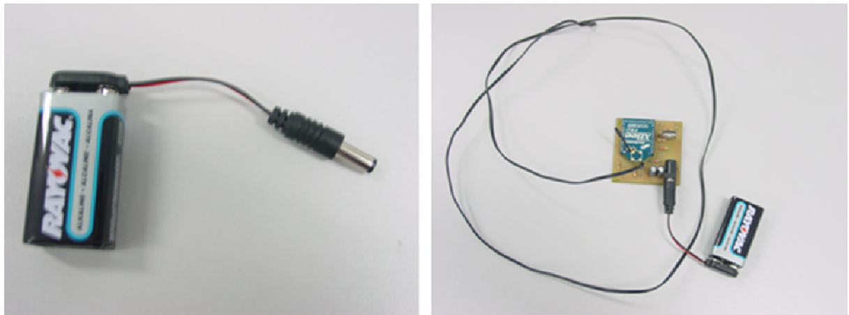
Figura 4.10 Bateria utilizada para alimentar a placa confeccionada (à esquerda); Placa em funcionamento sendo alimentada por uma bateria (à direita)
