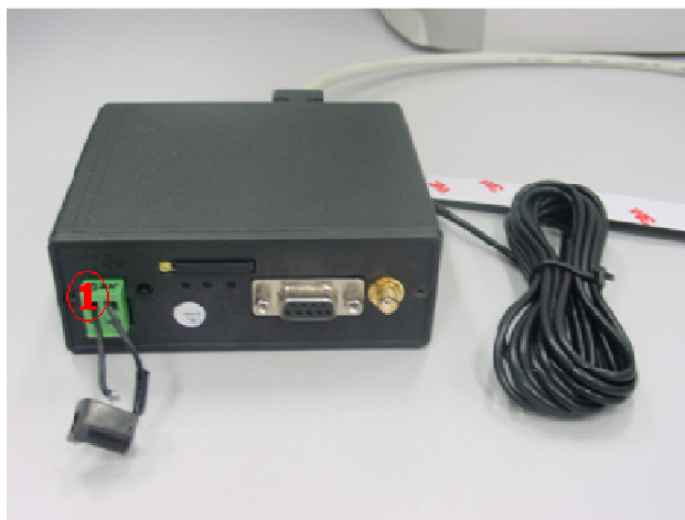
Figura 5. Modem com entrada de alimentação e antena GPRS.
