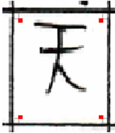
Figura 3.4 - Pontos de fronteira. Observe que há um afastamento entre os pontos e a borda, introduzido pela variável *offset*.
