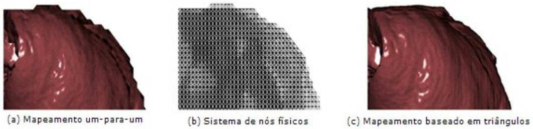
Figura 14. a) Modelo com mapeamento um-para-um entre o físico e o gráfico. b) Representação gráfica apenas do modelo físico (sistema massa-mola). c) Resultado esperado utilizando o mapeamento proposto por [42].
