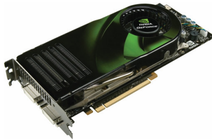
Figura 9. Exemplo de placa gráfica utilizada como co-processador físico no Havok .
