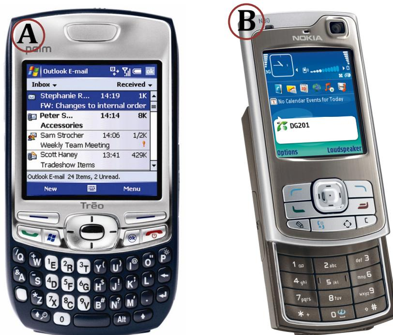
**Figura 3. Exemplos de *smartphones*: (a) PDA + telefonia; (b) celular + aplicações de PDA.**
