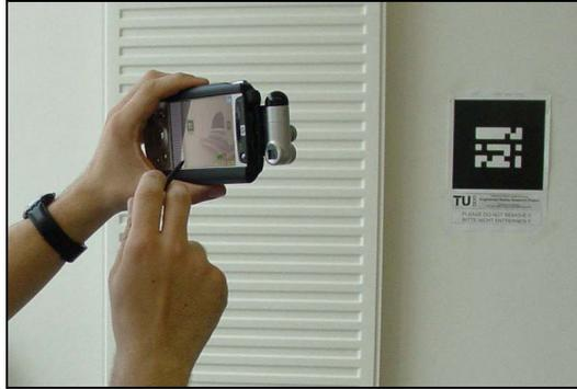
**Figura 6. Aplicação de RA em dispositivo móvel capaz de rastrear marcadores em tempo real.**
