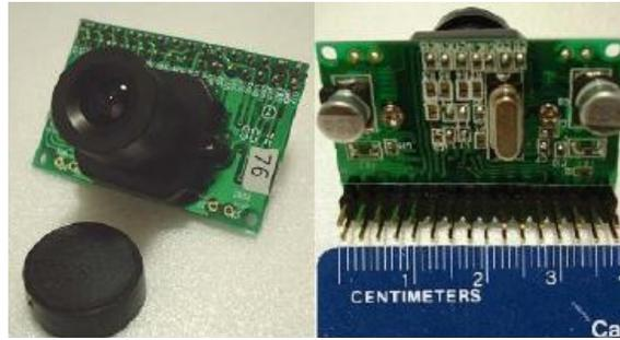
Figura 29: Sensor de imagem utilizado
