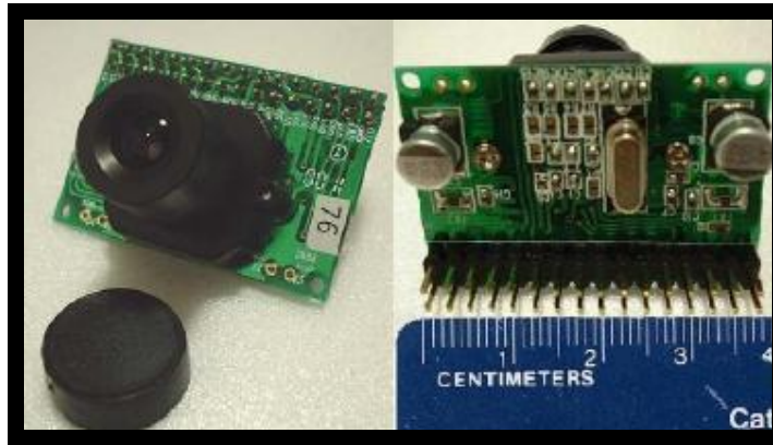
Figura 39. Placa que acomoda o sensor de imagem.
