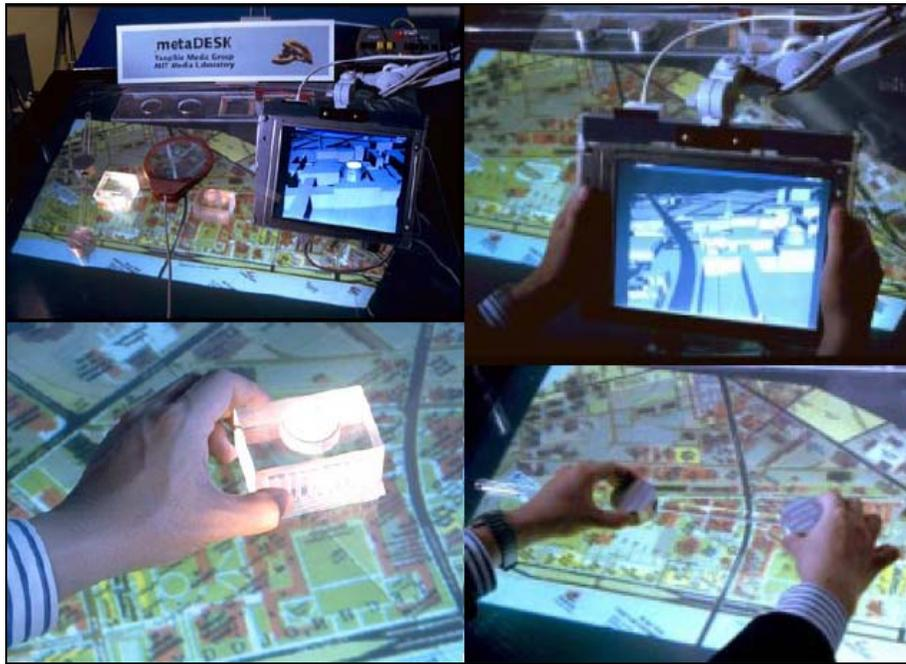
Figura 3.16 - Aplicação metaDesk, vista do sistema (cima esquerda), lentes mostrando uma vista 3D (cima direita), objeto com invólucro de acrílico (baixo esquerda) e objetos físicos reais (baixo direita) [44].
