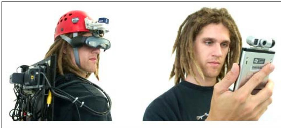
Figura 3.28 - Backpack tradicional para AR móvel (esquerda) versus um handheld (direita) [48]
