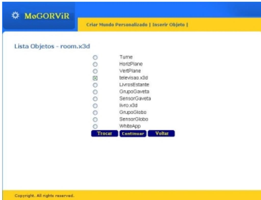
Figura 30 Tela que mostra os objetos existentes no mundo base. Estes objetos podem ser trocados por outros armazenados no SGBD.
