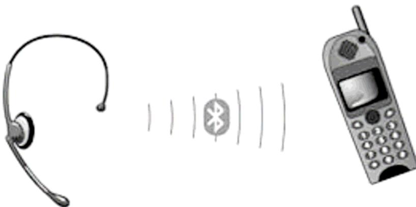
**Figura 4.4:** Você pode se comunicar com apenas um dispositivo Bluetooth caso você tenha um hardware Bluetooth que suporta conexão ponto-a-ponto.
