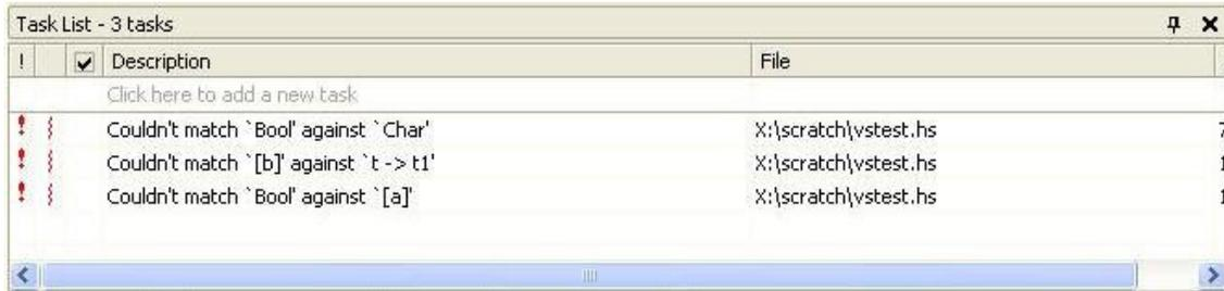
**Figura 38 – Mensagens de erro do próprio GHC exibidas na *tasklist* do VS.NET**
