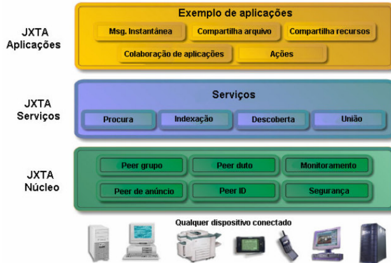
Figura 2.12 – Arquitetura em Camadas da Plataforma JXTA [Gong 2002]
