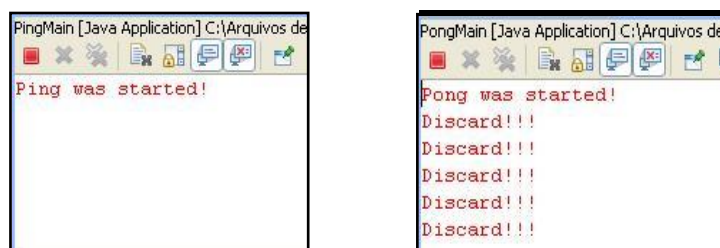
Figura 8: Aplicação executada com probabilidade um de ocorrência de falha por crash .
