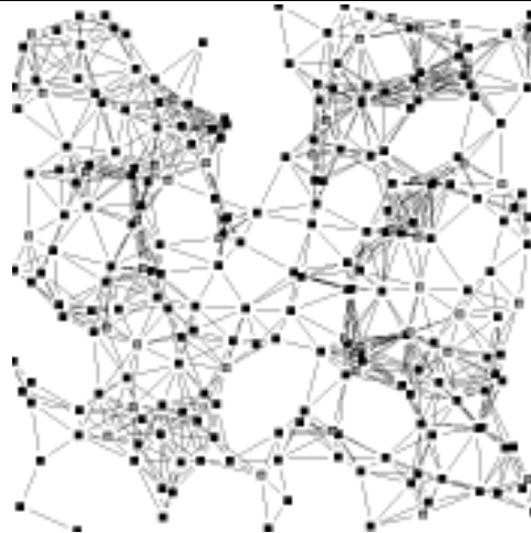
Figura 3.7 - Simulação de uma rede de 250 nós e 2522 conexões ao todo.
