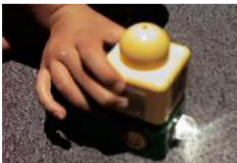
**Figura 3.9** *Electronic Blocks*: um bloco sensível ao toque, ao ser conectado a um bloco que emite luz, faz a luz acender sempre que o toque for detectado
