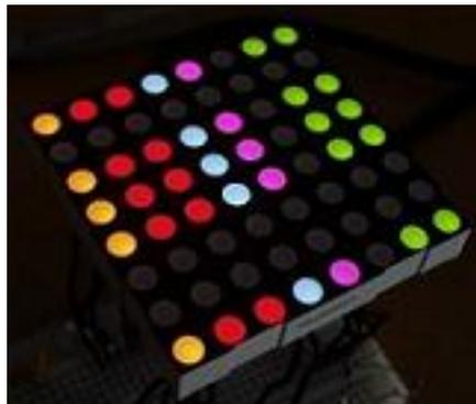
**Figura 8.5** Matriz de LEDs RGB, de dimensões 0.83 x 6.0 x 6.0cm. (Disponível em: <<http://www.sparkfun.com/>>. Acesso em: 26 jan. 2007.)
