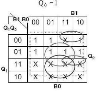
$$Q_0^* = D_0 = \underbrace{Bl(\overline{Q_1Q_2} + Q_1Q_2) + B0(Q_2 + Q_1) + Q_0}_{\text{Equação de excitação ou transição}}$$
